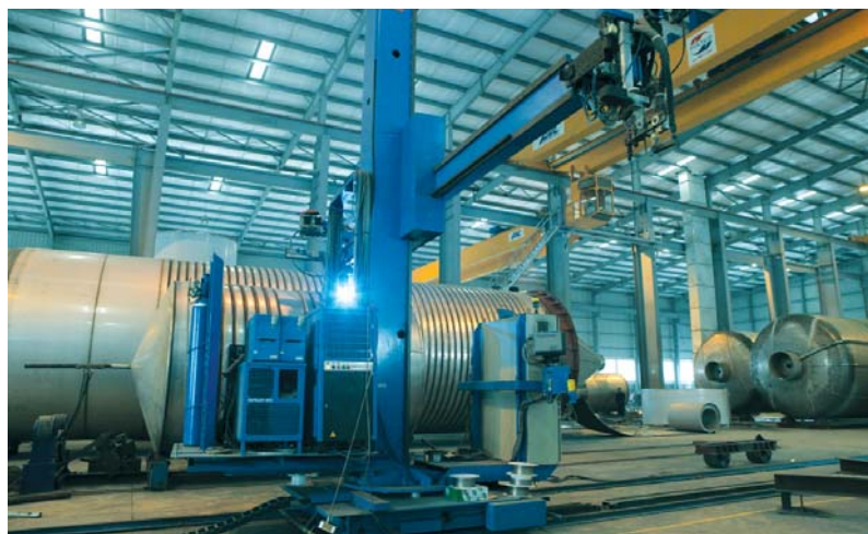
Máy hàn Plasma tự động hàn thân trụ và áo bao.
