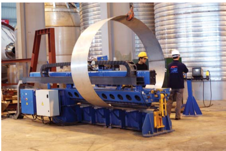
Máy hàn Plasma tự động hàn đường sinh.
